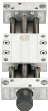
新的预紧型 AMS® ASLWE-PL 直线滑动平台相对标准型提供了一个额外优点。预紧型的轴向间隙通过 2 个梯形螺母调节。滑块可以手动调节。
